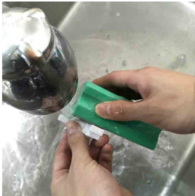
[도 28] 다이아몬드 사포를 이용한 2차 연마과정
