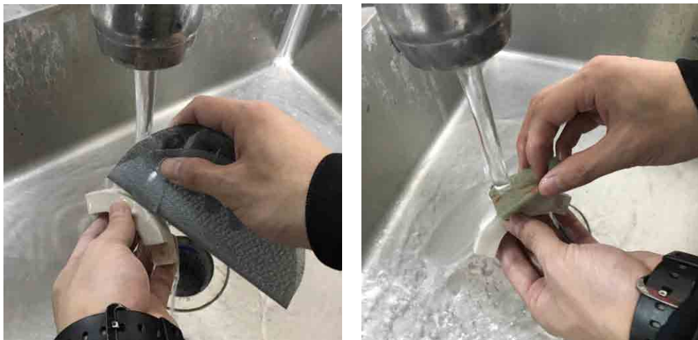
[도 26] 원형 망 사포와 3M 사포를 이용한 1차 연마 과정
