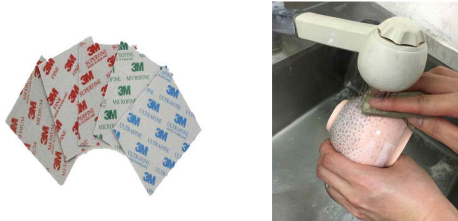
[도 27] 초벌 후 3M 스펀지를 이용한 사포 연마과정
