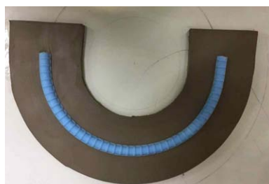
[도 31] 실리콘 원형을 이용한 Drain Casting 몰드 제작과정
