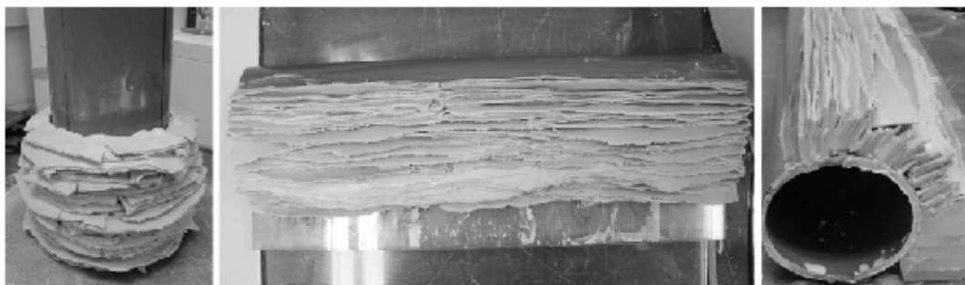
[도 37] PVC 파이프를 이용한 성형과정
