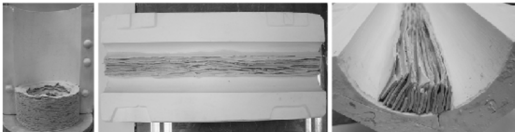
[도 36] 석고틀을 이용한 성형 과정
